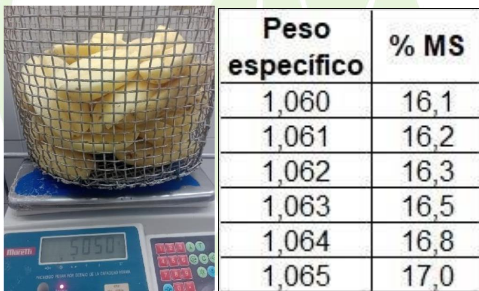
Figura 4. Izquierda: Balanza con canasto para pesaje en el aire y en agua de la muestra. Derecha: extracto de tabla para obtener el valor porcentaje de materia seca de la muestra a partir del peso
